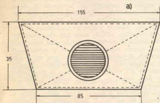
Fig. 2 - Interno della cappa: a) schema del ritaglio di lamiera; b) con la piegatura e la mascherina maritata. (Le misure sono espresse in cm.).
