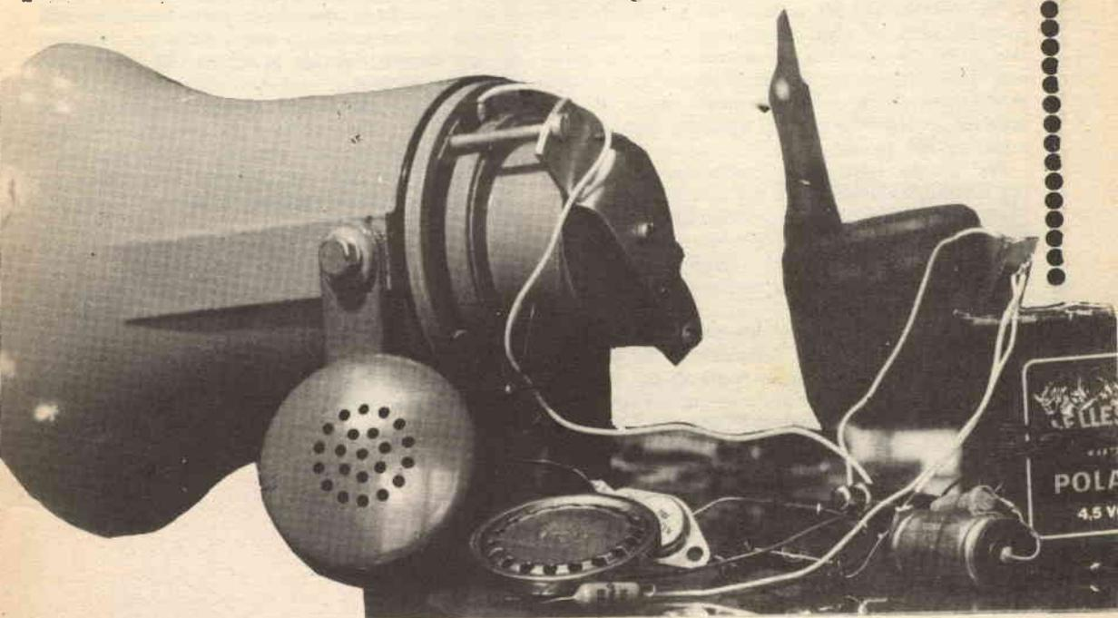
Vogliamo qui trattare di un megafono con amplificatore incorporato il cui circuito elettrico non presenta particolari caratteristiche, all'infuori del poco usuale tipo di microfono adoperato e del modo di inserzione dello stesso. Si usa infatti un microfono a carbone, del tipo telefonico, il quale per la sua bassa impedenza si presta egregiamente ad essere collegato direttamente alla base di un transistor.
