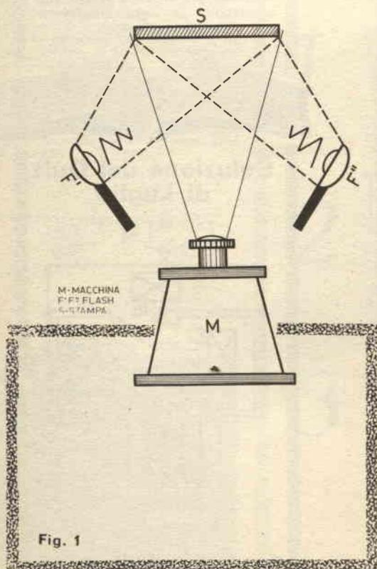
Per queste riproduzioni non occorre molto materiale: basta disporre di due lampade da 100 W, pellicola pancromatica, un bagno di sviluppo, un bagno di fissaggio e una macchina con mirino reflex (tipo Rolleiflex).
