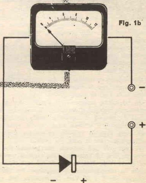
inversa al diodo, NON si avrà invece alcun passaggio di corrente (fig. 1).
