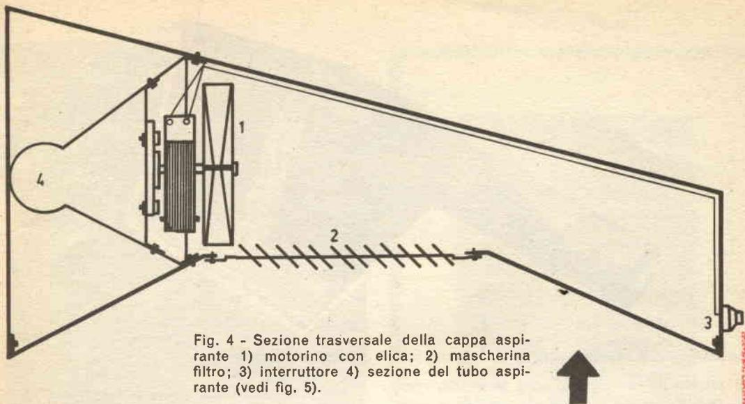
Fig. 4 - Sezione trasversale della cappa aspirante 1) motorino con elica; 2) mascherina filtro; 3) interruttore 4) sezione del tubo aspirante (vedi fig. 5).
